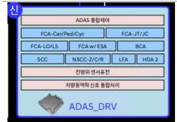
그림93 현대차의 통합제어기 신규 통합 아키텍처: 23년부터는 커넥티드카 유닛으로도 자율주행 OTA 지원
