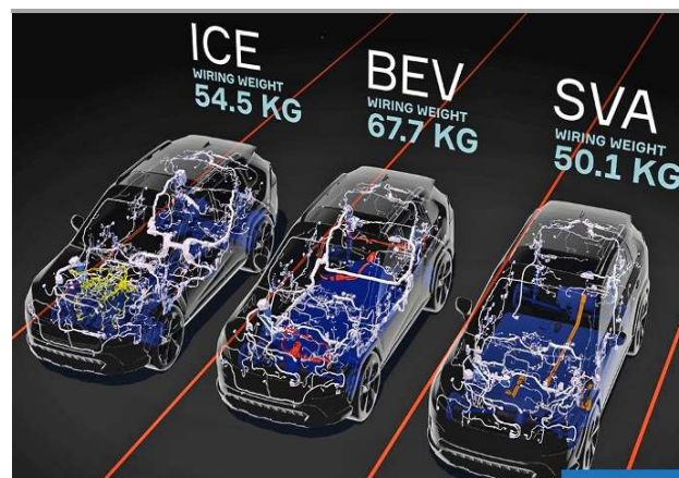
그림18 Aptiv의 SVA(Smart Vehicle Architecture), 중복기능의 ECU 수를 빠르게 줄이는 핵심 기술
